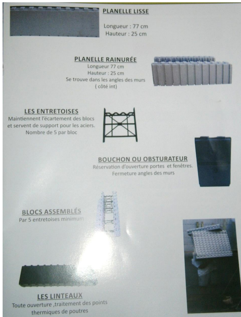
Figure 2 : Les différents modules composants les blocs Néopor, Source : Dépliant sur le site, www.blokice.com
