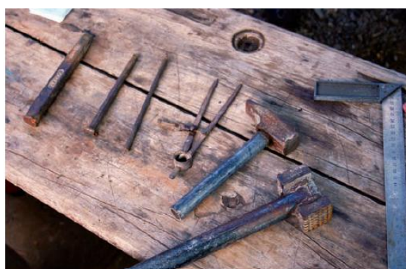
Figure 2 : Les outils traditionnels utilisés par le tailleur de pierre, Source : www.cndp.fr/crdp-reunion/sites/default/files/dossiers.../crdp-prec1.pdf
